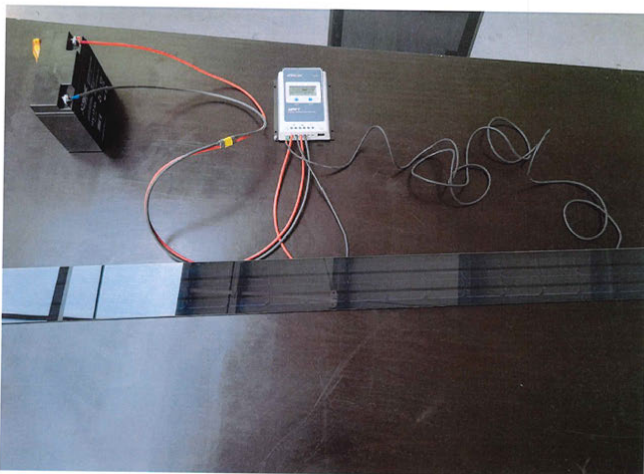
Na powyższym rysunku przedstawiono system połączenia lameli fotowoltaicznej generującej prąd stały do
