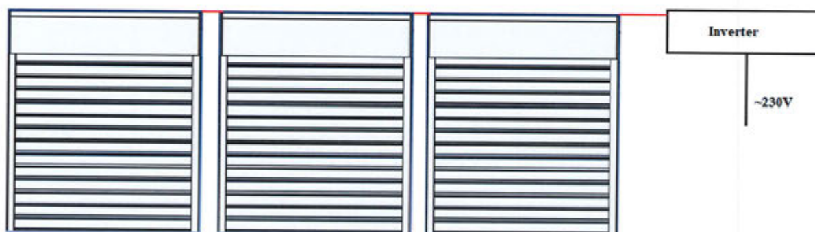
Układ standardowego połączenia w szereg rolet fotowoltaicznych.
