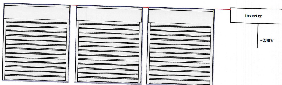
Układ standardowego połączenia w szereg rolet fotowoltaicznych.
