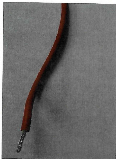
Rys. 4.5. Kabel o dużo większej elastyczności powłoki
