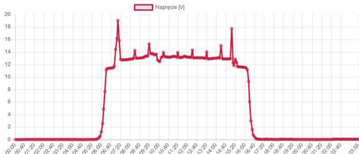
Rys. 1.21. Przebieg napięcia paneli fotowoltaicznych w funkcji całodobowej – dzień 2
