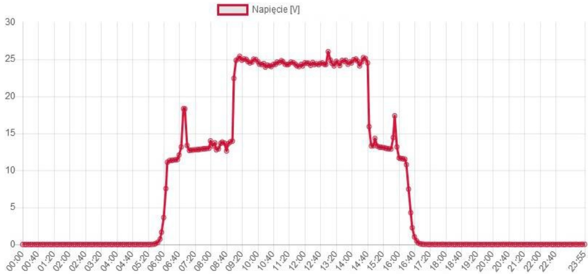
Rys. 1.24. Przebieg napięcia paneli fotowoltaicznych w funkcji całodobowej – dzień 5
