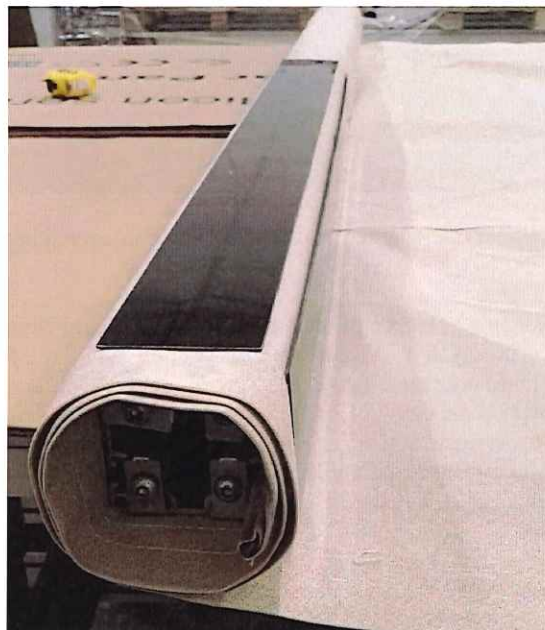
Rys. 2.2. Poszycie elastyczne z zamontowanymi lamelami fotowoltaicznymi w badaniach
