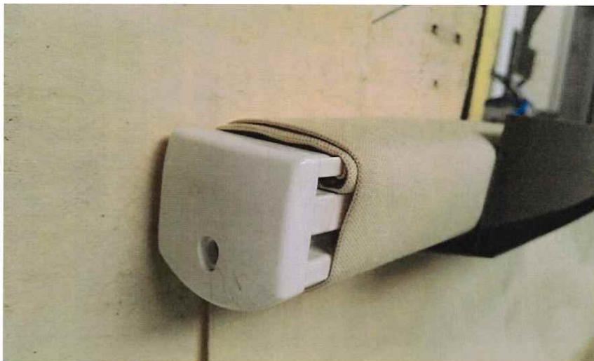
Rys. 2.3. Zabezpieczenie poszycia na rdzeniu obrotowym
