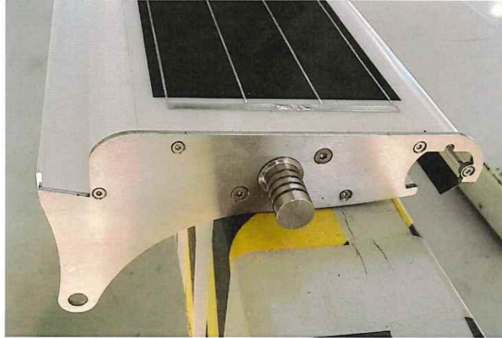
Rys. 2.7. Zakończenie zamykające lamelę sztywną z elementem łącznym do konstrukcji nośnej Prowadzone są również badania w zakresie integracji poszczególnych elementów systemu czego przykładem jest element łączący sztywną lamelę z konstrukcją nośną markizy, umożliwiającą przeniesienie obciążeń oraz energii elektrycznej wytworzonej przez markizę do magazynu energii. Badania prowadzone są na opracowanym stanowisku badawczym umożliwiającym symulowanie działania w układzie kinematycznym z zastosowaniem napędów elektrycznych i ręcznym (rys. 2.8).
