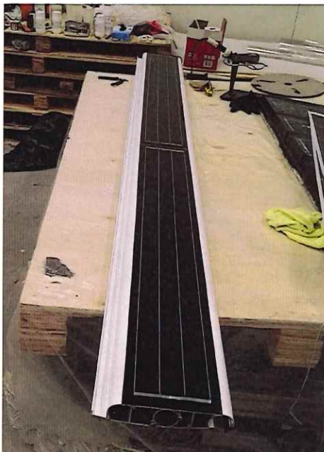
Rys. 2.6. Sztywna lamela zintegrowana z kompozytowanym modułem fotowoltaicznym
