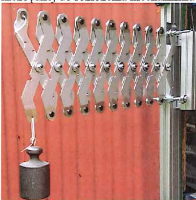
Rys. 3 Sposób obciążania mechanizmu nożycowego podczas badań
